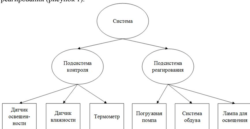
*Рисунок 1 – структурная схема системы*
